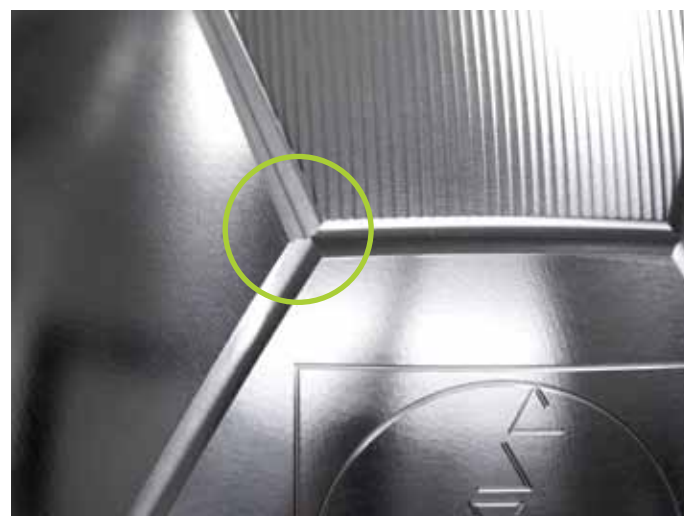
闭环： 由于海德汉高精度直线光栅尺和角度编码器，驱动系统的误差对加工结果没有影响。接缝宽度铣削准确，交点相交在正确位置。
