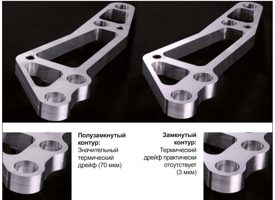
Рисунок 5 Шарнирный рычаг, дважды обработанный из одной заготовки
